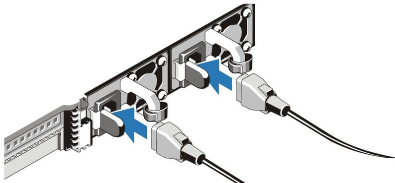
図 3. 電源ケーブルの接続
