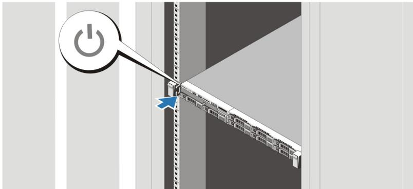
図 5. システムの電源投入
