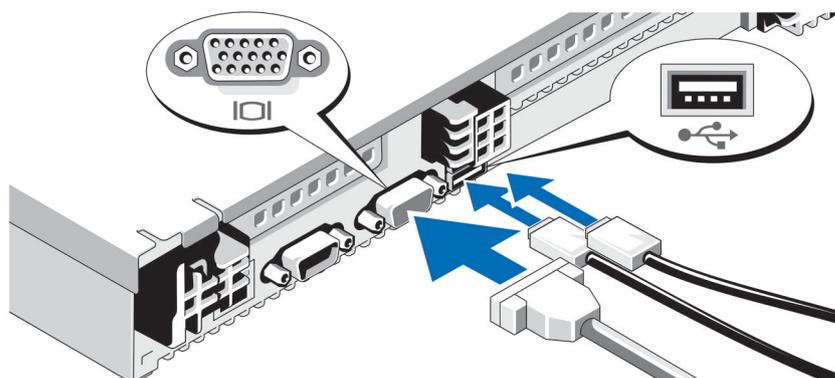
図2. キーボード、マウス、モニタの接続
